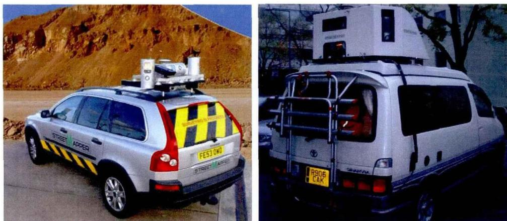
图 1.7 车载激光雷达及数码成像系统 StreetMapper
