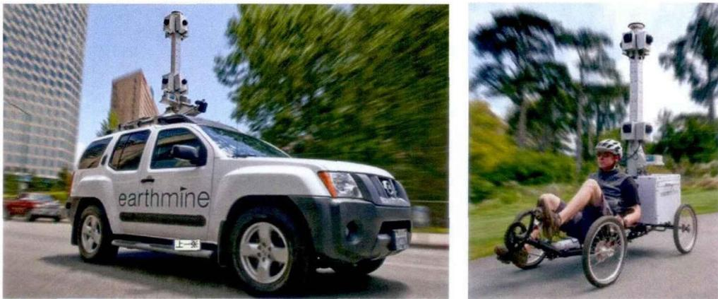
图 1.8 Earthmine 公司的立体全景测量车
