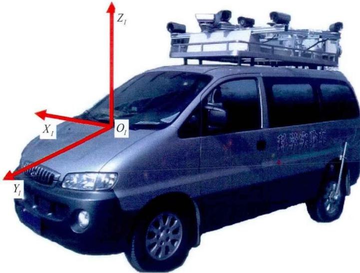
图 4.18 安装汽车上惯导的坐标系
