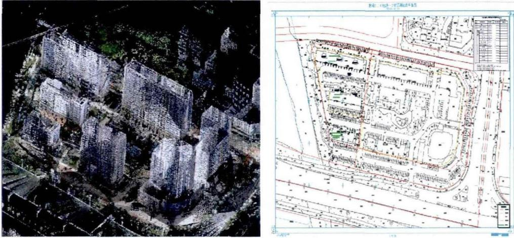
图 7.15 建筑竣工原始点云与竣工图
