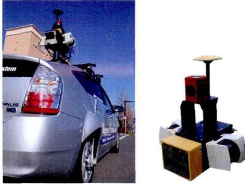
图 1.9 Topcon 公司的 IP-S2 激光扫描测量系统
