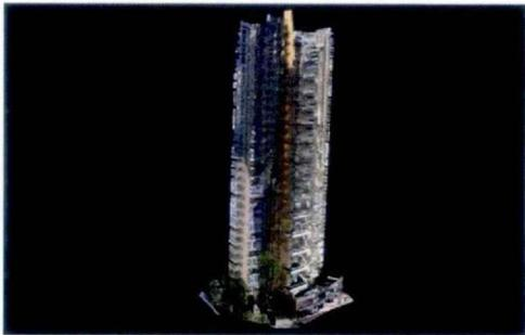
图 7.21 建筑的带颜色渲染的点云
