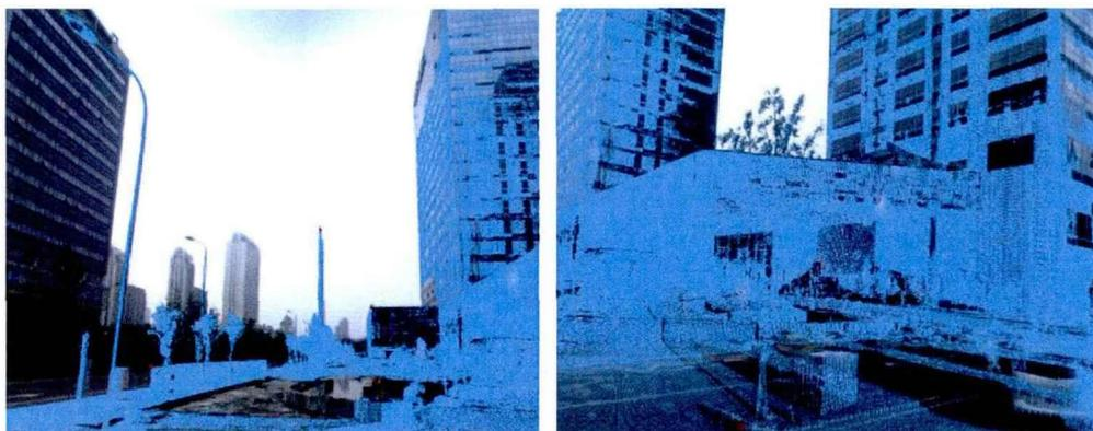
图 6.30 车载点云与全景影像配准后的结果
