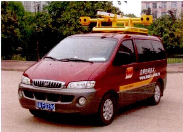
图 1.10 LD2000-R 型移动道路测量系统
