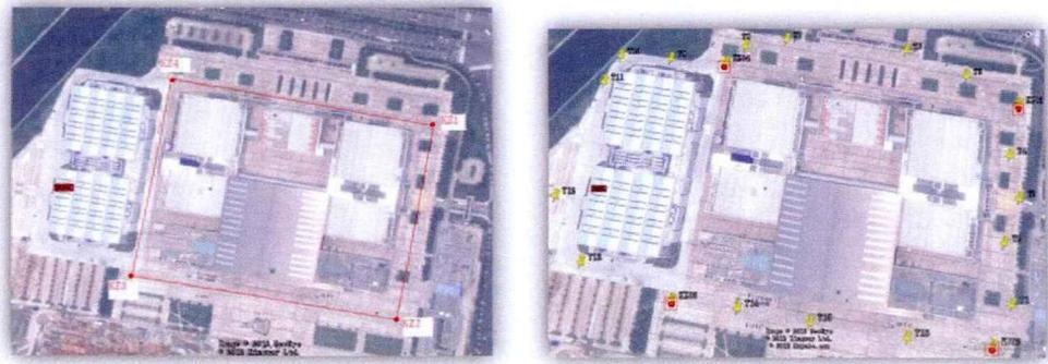
图 6.7 标定场控制点（左图：一级控制点，右图：二级控制点）
