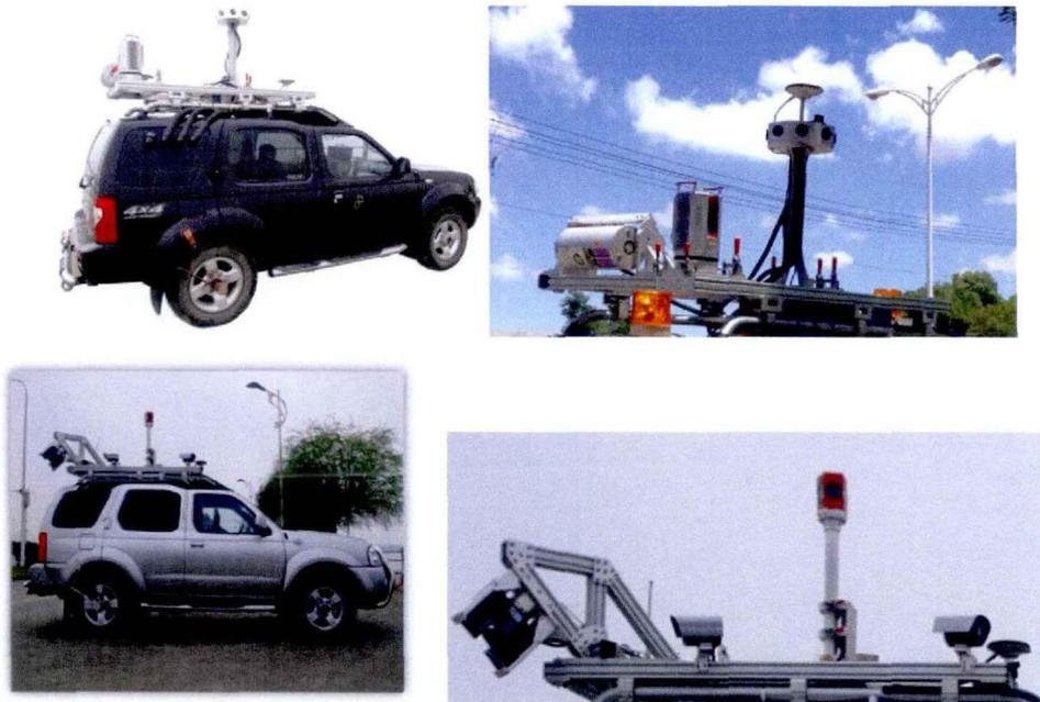
图 7.1 车载三维激光与全景影像智能测量系统
