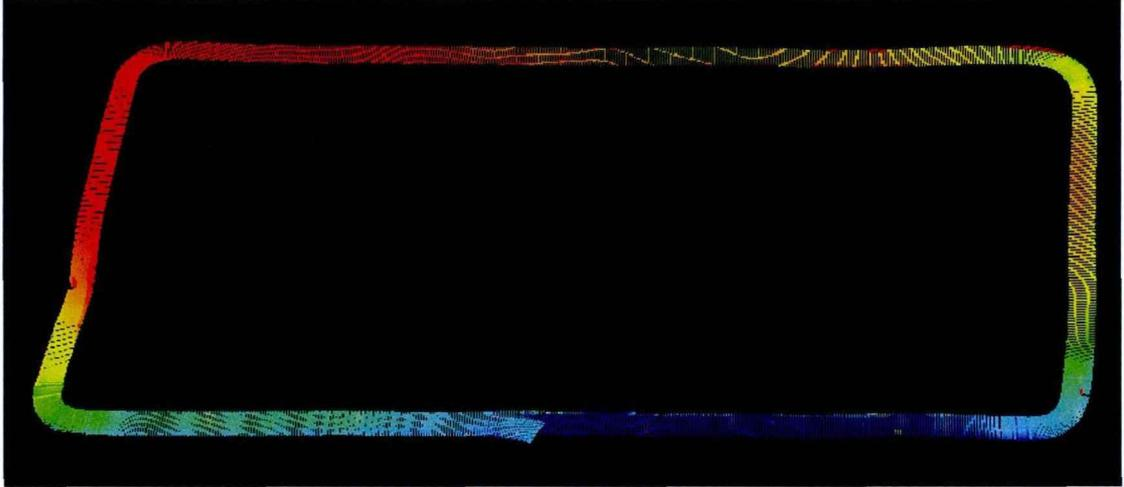
图 6.13 Riegl LMSQ120i 条带状道路面数据
