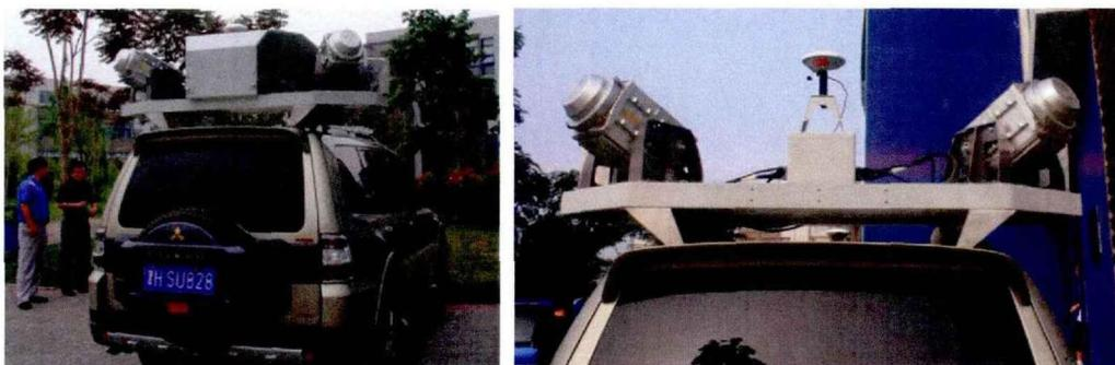
图 1.6 车载移动激光扫描测量系统 Lynx
