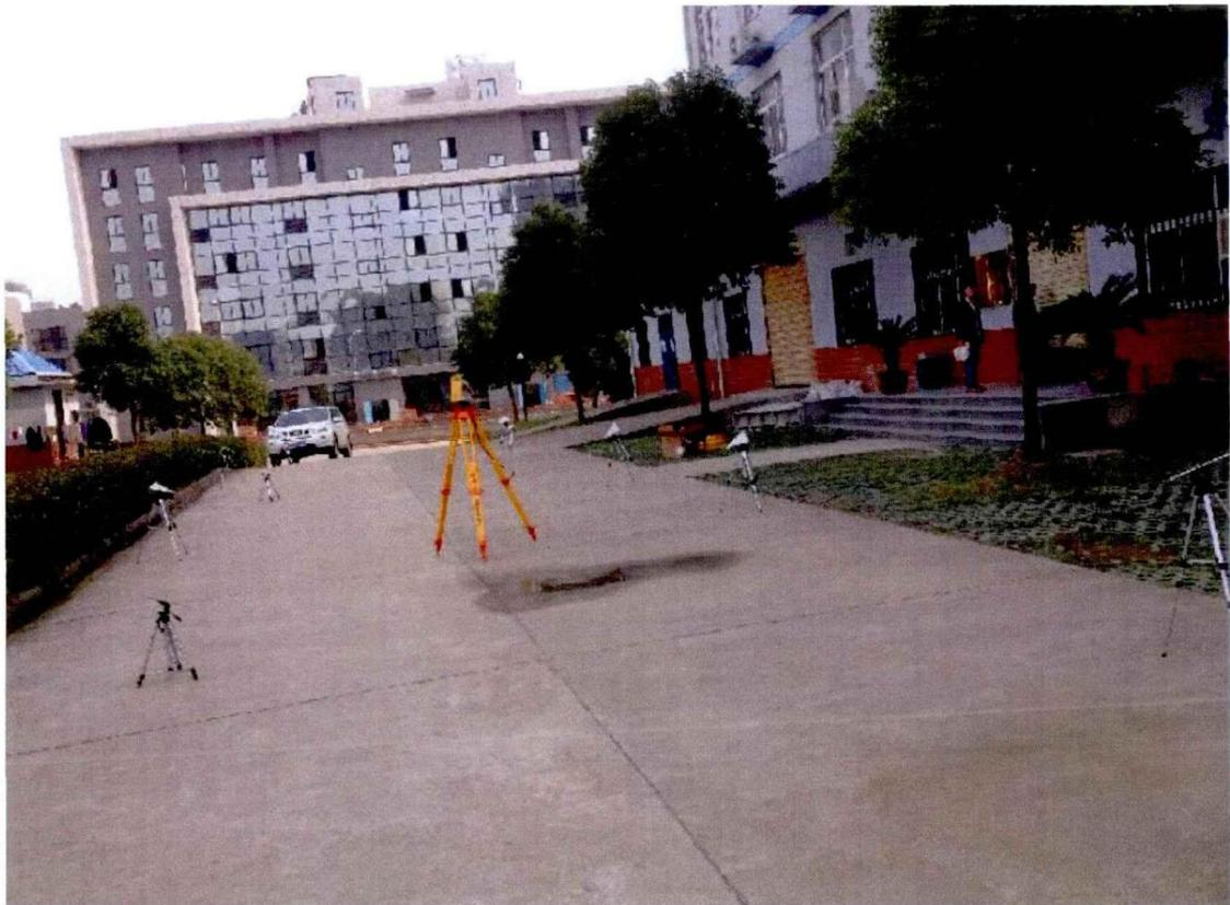
图 6.14 使用三角标志对 Riegl LMSQ120i 进行绝对标定
